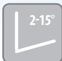
Pose admise dans des pentes de toitures de 2° à 15°.
