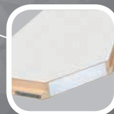
La trappe spéciale de 8cm d'épaisseur, remplie uniquement avec une matière thermo-isolante (polystyrène), assure une excellente barrière réduisant les pertes de chaleur.
