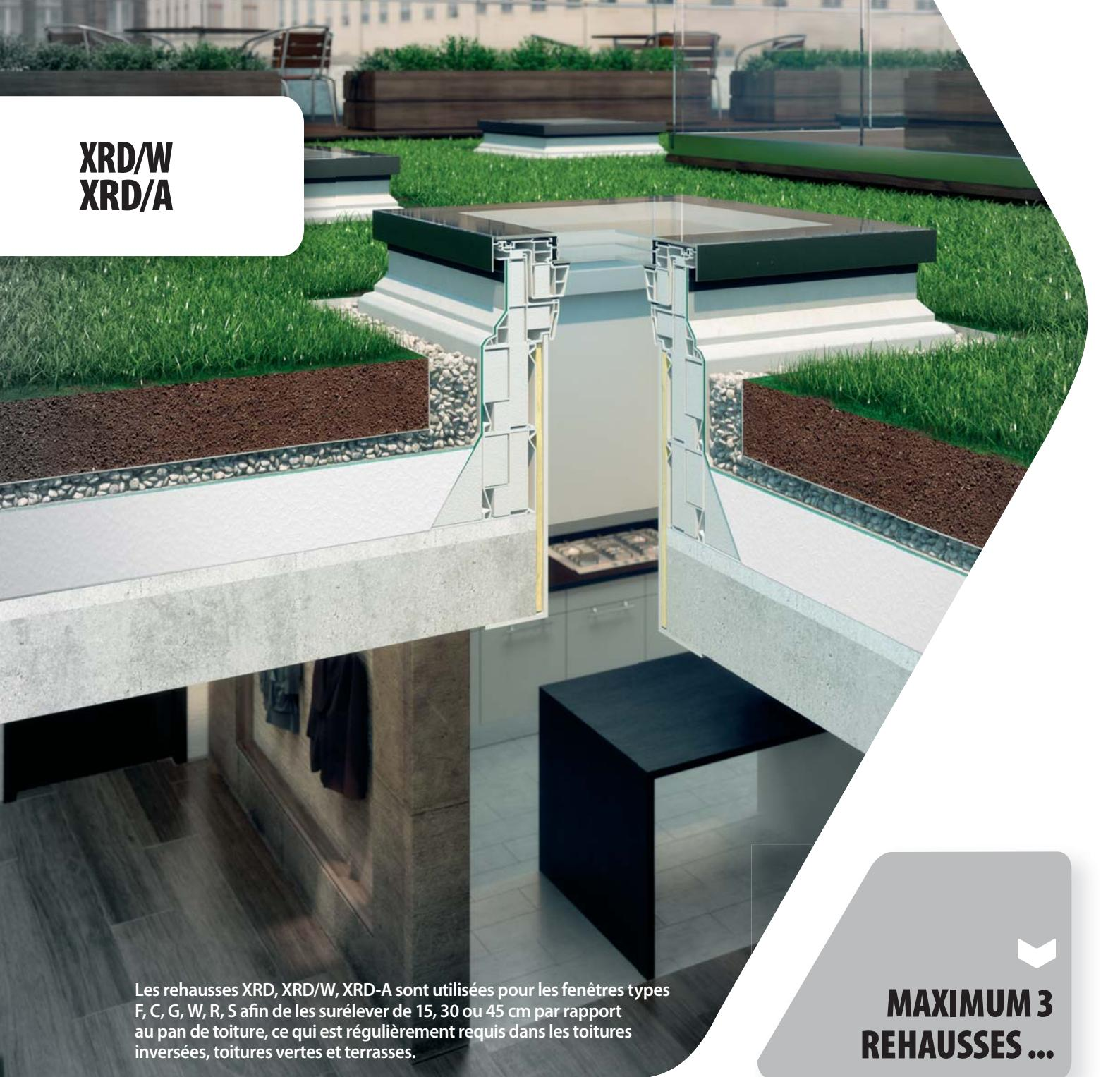
Les rehausse XRD, XRD/W, XRD-A sont utilisées pour les fenêtres types F, C, G, W, R, S afin de les surélever de 15, 30 ou 45 cm par rapport au pan de toiture, ce qui est régulièrement requis dans les toitures inversées, toitures vertes et terrasses.
