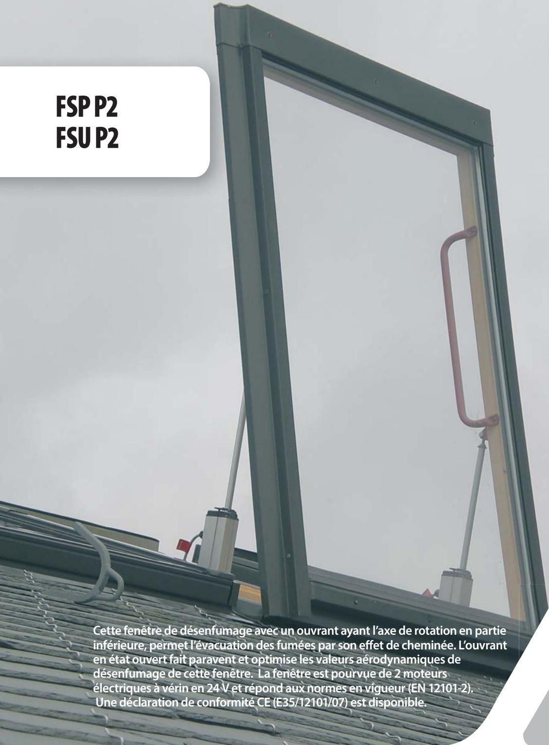
Cette fenêtre de désenfumage avec un ouvrant ayant l'axe de rotation en partie inférieure, permet l'évacuation des fumées par son effet de cheminée. L'ouvrant en état ouvert fait paravent et optimise les valeurs aérodynamiques de désenfumage de cette fenêtre. La fenêtre est pourvue de 2 moteurs électriques à vérin en 24 V et répond aux normes en vigueur (EN 12101-2). Une déclaration de conformité CE (E35/12101/07) est disponible.
