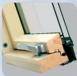
Les fenêtres **en bois** naturel sont d'une qualité extraordinaire. La menuiserie en pin est composée de lattes, collées ensemble par assemblage à micro-denture. La menuiserie est imprégnée sous-vide et est pourvue de 2 couches de vernis incolore.
