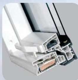
Les fenêtres les plus faciles à entretenir sont incontestablement les fenêtres en **PVC**. Les profilés extrudés à renforts métalliques, n'absorbant pas l'humidité, sont durables et résistants à la corrosion. Ces fenêtres sont destinées aux pièces d'eau avec un taux d'humidité constant et élevé.
