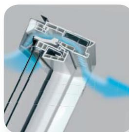
Entrée d'air réglable avec grille de ventilation, installée en partie haute dans le cadre dormant de la fenêtre. Ce système de ventilation offre en fonction de la largeur de la fenêtre un débit jusque 18 m<sup>3</sup>/h (à 2 Pa). Pour les locaux où une ventilation normale est exigée.
