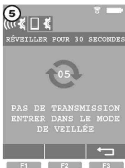
Cette télécommande reste dans le mode de veille jusqu'à 30 secondes à partir de la fin de la transmission des données. Une fois cette période terminée, la télécommande passe automatiquement dans le mode de endormi.
