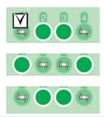
Après quelque secondes, le module signalera le succès de l'opération en alternant l'allumage des diodes.
