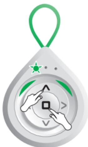
Maintenir en même temps les touches boutons ARRÊT et BAS jusqu'à ce qu'une lumière VERTE s'allume et la diode D1 commence à clignoter.
