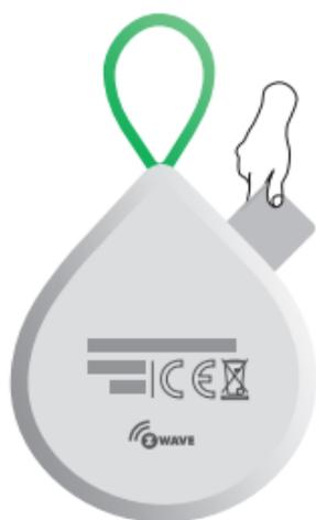
Avant d'utiliser la télécommande ZRG3 il faut enlever le film de protection des piles contre le déchargement.
