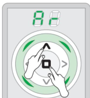
Appuyez le bouton HAUTE et STOP en même temps jusqu'au moment d'entrée dans le mode de configuration.
