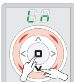
Appuyez le bouton BAS et STOP en même temps jusqu'au moment d'entrée dans le mode de configuration.
