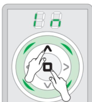
Appuyez le bouton HAUTE et STOP en même temps jusqu'au moment d'entrer dans le mode de configuration.
