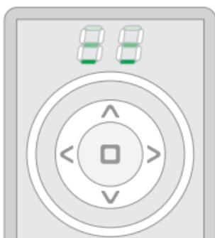
2 lignes circulant cycliquement apparaissent pour quelques secondes.
